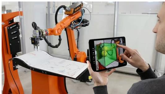
Grazie al nuovo pacchetto software KUKA.MixedReality, prima di mettere in funzione la macchina si possono visualizzare sul dispositivo mobile, in tempo reale, gli strumenti e le geometrie di interferenza del robot, evidenziando gli eventuali pericoli per gli operatori o le attrezzature.
