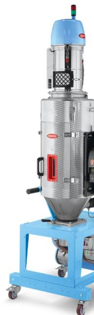
MINI DRYER X COMB. Ideato e sviluppato da Moretto, questo dispositivo è completamente elettrico e non richiede acqua o aria per il suo funzionamento - con prestazioni superiori rispetto ai deumidificatori convenzionali, assicurando elevata qualità nel trattamento di polimeri tecnici grazie all'adozione di set molecolari interamente in zeolite. Il tutto garantendo un Dew Point con rendimenti fino a  $-61^{\circ}\text{C}$ , indipendentemente dalle condizioni ambientali esterne.
