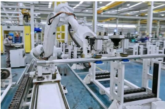
Qui i robot sono presenti ovunque: nel magazzino automatico e a fianco degli operai, anche in una fase molto delicata dell'assemblaggio come l'inserimento delle colonne nel gruppo di chiusura, eseguita da una coppia di robot antropomorfi a sei assi; operazione che se non viene eseguita con estrema precisione rischia di danneggiare le boccole. A questa fabbrica abbiamo dedicato un articolo particolareggiato ([leggi](#)).
