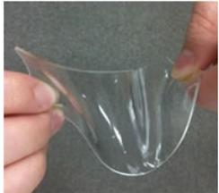
La giapponese Kuraray avvierà presso il sito di Niigata un impianto per la produzione di una nuova famiglia di elastomeri termoplastici acrilici. Si tratta di copolimeri a blocchi che combinano la trasparenza e la resistenza del metilmetacrilato (MMA) con l'elasticità e le buone proprietà di adesione del butil acrilato (BA).
